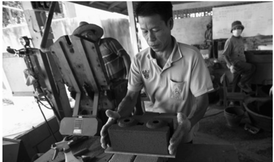
Un futuro propietario de una casa Hábitat aprende a fabricar bloques machimbrados en la comunidad de Muang Len en Chiang Mai, Tailandia. Los bloques se usaron para construir dos casas en la comunidad y complementar otros bloques comprados para el Proyecto Jimmy & Rosalynn Carter en 2009. Los propietarios ganaron "capital de trabajo" (sweat equity) al fabricar los bloques para sus casas y para las de otros y, además, aprendieron habilidades importantes que pueden aportar a su sustento futuro.
