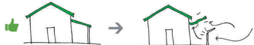
Nuestro corredor o terraza techada debe tener un techo separado para que si el viento sopla, se lleve tan solo ese techo auxiliar y nuestro techo principal no se vea afectado.
