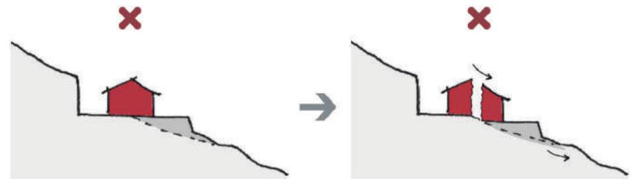
Si la tierra de nuestro solar está compuesta de material de relleno, tenemos que evitar colocar la cimentación sobre ese terreno, ya que esta tierra no está suficientemente compactada para soportar la estructura y la casa podría deslizarse.
