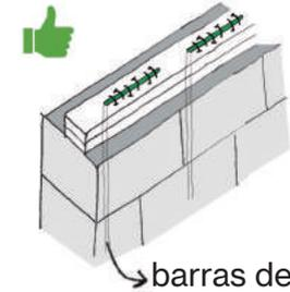
Si ya hay barras de acero entre los bloques, la mejor solución es doblarlos y reforzar la unión con clavos en ambas direcciones.
