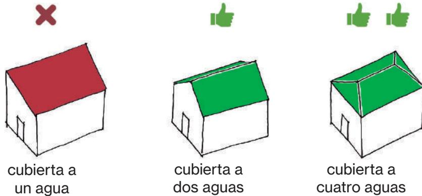
La cubierta a un agua no se recomienda ya que es la forma menos resistente. La cubierta a dos aguas es un poco mejor pero la forma más resistente es la cubierta a cuatro aguas porque es la más aerodinámica.
